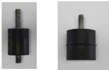
Fig1. 円筒状防振ゴムサンプル (2通り)
