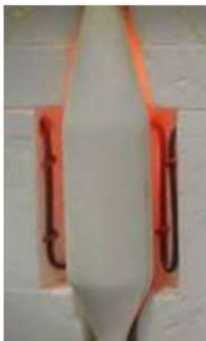
Fig1. 繊維強化セラミック製インサート (1300℃対応)
